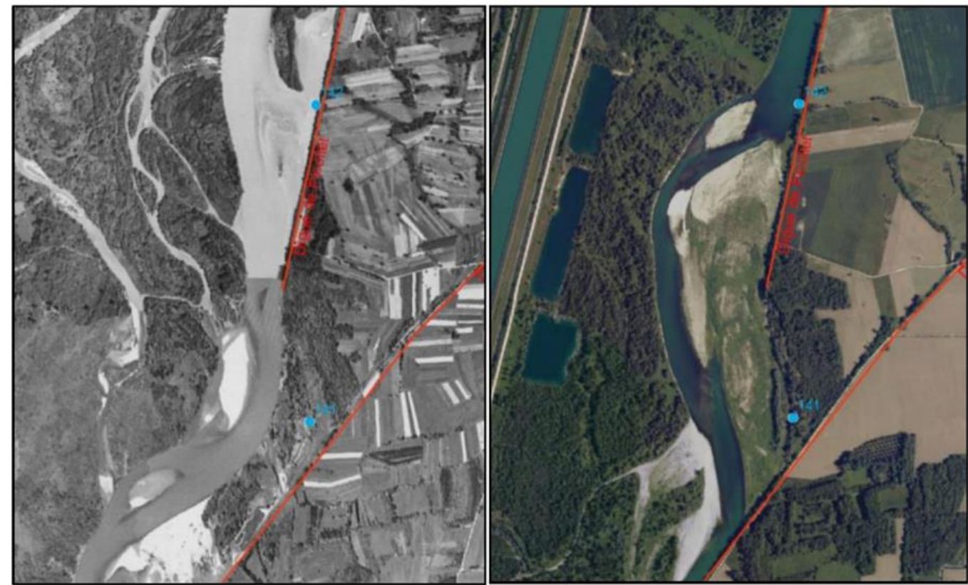
Comparaison de photos aériennes sur la Chautagne (1952-2005) : inversion de la courbe du méandre et influence sur la digue de Picollet et de Serrières
